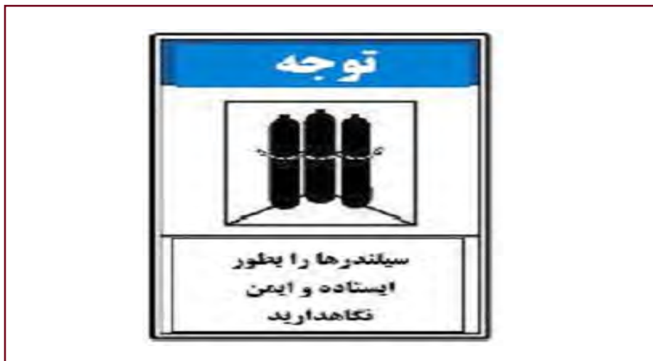
شکل ۴-۱۹: علامت ایمنی در خصوص نگهداری صحیح سیلندرها
